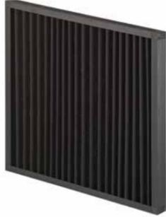
Bei dem APAK-Filter handelt es sich um eine Aktivkohlefilterplatte, die in einem Kunststoffrahmen montiert ist. Das Medium ist mit Aktivkohlepulver beschichtet. Dieser Filter wird zur Filtration von gasförmigen Partikeln und zur Behandlung von Gerüchen eingesetzt. Dieser Filter entspricht der Prüfnorm ISO 16890 und ist in der Filterklasse ISO Coarse 70% erhältlich.
