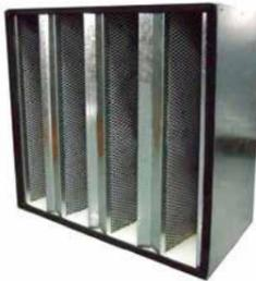
Der AC-VB-Filter ist ein Aktivkohlefilter, der in einem verzinkten Stahlrahmen montiert ist. Auf der Vorderseite hat er eine Gummidichtung. Dieser Filter ist mit 4 mm großen Aktivkohlepellets gefüllt, die sich durch ihre hohe Adsorptionskapazität auszeichnen. Dieser Filter wird zur Filtration von gasförmigen Partikeln sowie in Einrichtungen, wie Museen und Archiven, sowie in der Industrie eingesetzt.
