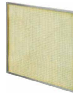
Die GPMC Filterplatte besteht aus einem Glasfaserfiltermedium und ist in einem verzinkten Stahlrahmen sowie einem Metallgitter montiert. Er wird als Vorfilter für allgemeine Lüftungsanlagen, für die Industrie oder für Lackierkabinen eingesetzt. Dieser Filter ist in ISO Coarse 50% erhältlich.
