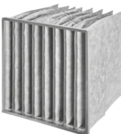
Le HQ-AK est un filtre à poches qui combine la filtration particulaire et moléculaire. Il est assemblé avec un cadre en acier galvanisé ou en aluminium et un média filtrant en microfibre de verre à haut avec couche de charbon actif.
