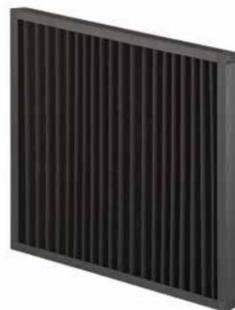
Le filtre APAK est un panneau filtrant en charbon actif assemblé dans un cadre plastique. Le média est recouvert d'une poudre en charbon actif. Ce filtre est utilisé pour la filtration des particules gazeuses et le traitement des odeurs. Ce filtre est conforme à la norme ISO 16890 et est disponible en classe filtrante ISO Coarse 70%.
