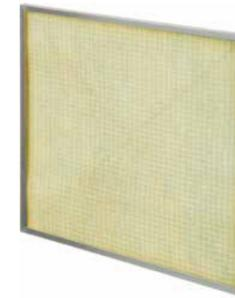
Le panneau filtrant GPMC est composé d'un média filtrant en fibre de verre et est assemblé dans un cadre en acier galvanisé ainsi qu'une grille en métal. Il est utilisé en tant que préfiltre pour système de ventilation générale, l'industrie ou les cabines de peinture. Ce filtre est disponible en classe filtrante ISO Coarse 50%.
