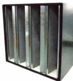
Le filtre AC-VB est un filtre en charbon actif assemblé dans un cadre en acier galvanisé, il est composé d'un joint en caoutchouc sur la face avant. Ce filtre est rempli de pellet en charbon actif mesurant 4mm, ceux-ci se caractérisent par leur haute capacité d'adsorption. Ce produit est utilisé pour la filtration des particules gazeuses et dans les applications comme les musées, les archives et les industries.
