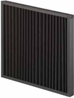
Bei dem APAK-Filter handelt es sich um eine Aktivkohlefilterplatte, die in einem Kunststoffrahmen montiert ist. Das Medium ist mit Aktivkohlepulver beschichtet. Dieser Filter wird zur Filtration von gasförmigen Partikeln und zur Behandlung von Gerüchen eingesetzt. Dieser Filter entspricht der Prüfnorm ISO 16890 und ist in der Filterklasse ISO Coarse 70% erhältlich.
