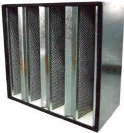
Der AC-VB-Filter ist ein Aktivkohlefilter, der in einem verzinkten Stahlrahmen montiert ist. Auf der Vorderseite hat er eine Gummidichtung. Dieser Filter ist mit 4 mm großen Aktivkohlepellets gefüllt, die sich durch ihre hohe Adsorptionskapazität auszeichnen. Dieser Filter wird zur Filtration von gasförmigen Partikeln sowie in Einrichtungen, wie Museen und Archiven, sowie in der Industrie eingesetzt.
