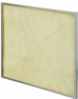
Die GPMC Filterplatte besteht aus einem Glasfaserfiltermedium und ist in einem verzinkten Stahlrahmen sowie einem Metallgitter montiert. Er wird als Vorfilter für allgemeine Lüftungsanlagen, für die Industrie oder für Lackierkabinen eingesetzt. Dieser Filter entspricht der Prüfnorm ISO 16890 und ist in der Filterklasse ISO Coarse 50% erhältlich.
